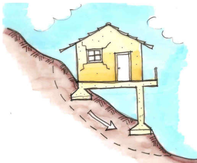
Figura 14a – Ilustração de uma moradia construída por sobre a massa escorregada
