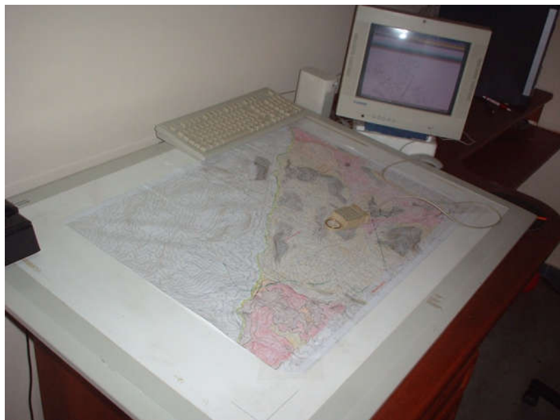
Figura 4. 8 Digitalização dos mapas confeccionados a partir de esboços realizados por meio de consulta à documentos existentes, imagens de satélite e trabalho de campo (PMRR, 2007).
